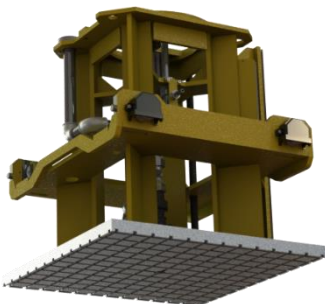
Universalbegasungsplatte mit flexibel definierbaren Begasungszonen
